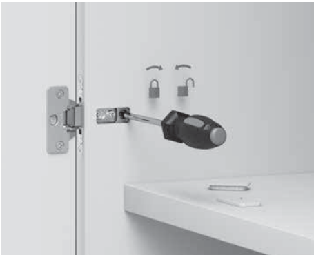
Blockierung und Einstellung des Scharniers an der Seitenwand
